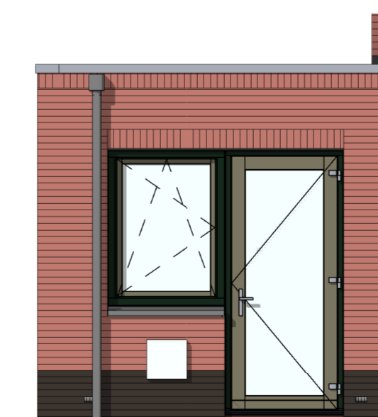
AG5025 - Enkele loopdeur en raam met gemetselde borstwering in achtergevel zijaanbouw
