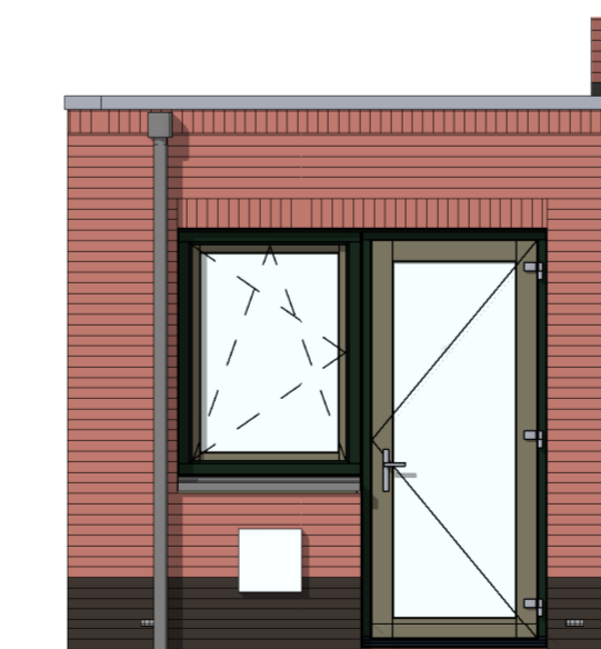
AG5025 - Enkele loopdeur en raam met gemetselde borstwing in achtergevel zijaanbouw
