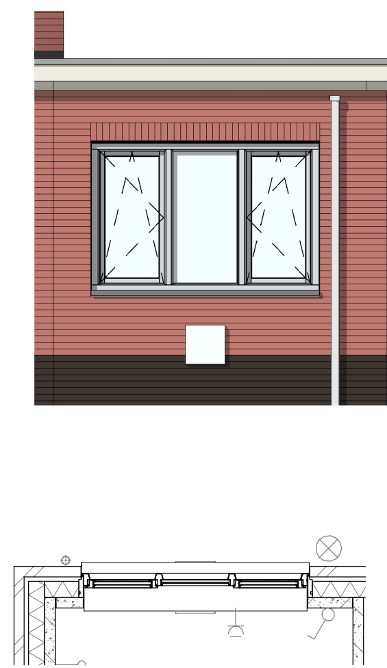
AG5024 - Kozijn met gemetselde borstwering in achtergevel aanbouw
