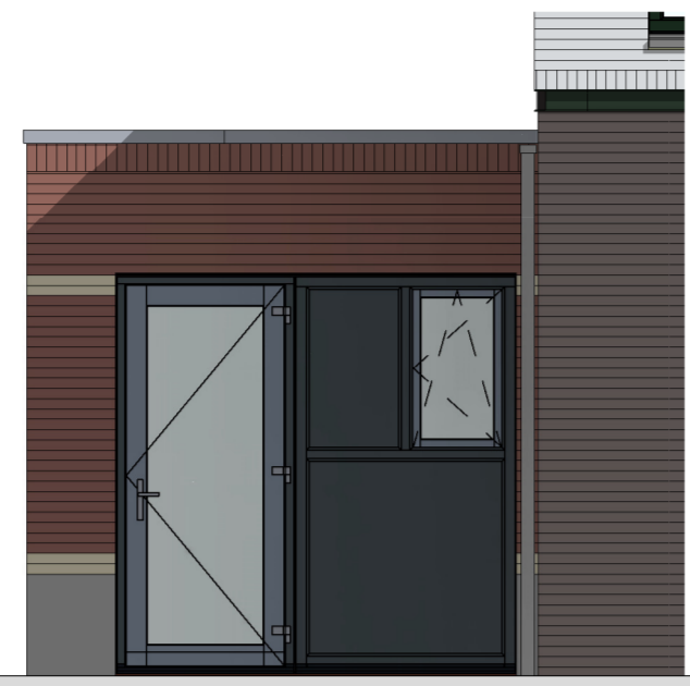
PL0006 - Splitsing in berging en bijkeuken met een andere pui in de voorgevel (Alleen mogelijk i.c.m. uitbouw 1200 of 2400 mm)
