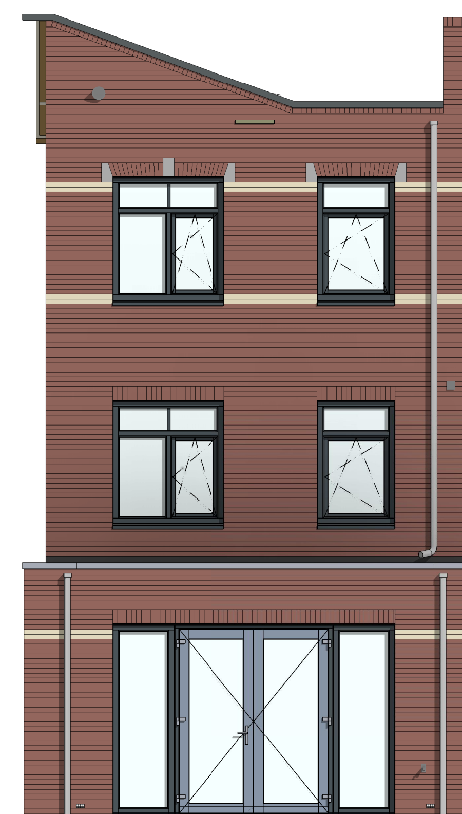
AB5424 - Aanbouw achtergevel, 2400mm AG5003 - Achtergevel voorzien van dubbele openslaande deuren met 2 zijlichten
